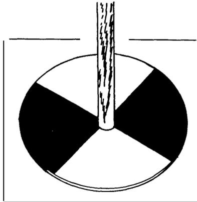
*Fig.1. Secchi disc.*
